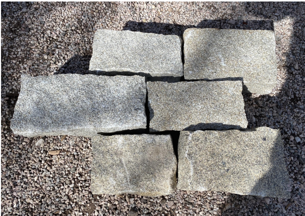
HRANOLY ŠTÍPANÉ, ŽULOVÉ, ŠÍŘKA 10 cm, VÝŠKA 10 cm, DÉLKA PROMĚNNÁ
